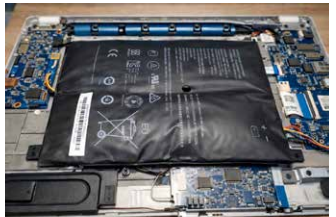
Fotografia 2. Zdeformowane (spuchnięte) ogniwo litowo-jonowe, będące elementem laptopa. Tego typu uszkodzenie polega na pęcznieniu obudowy ogniwa, które jest efektem gromadzenia się gazów powstających w wyniku niepożądanych reakcji chemicznych zachodzących wewnątrz akumulatora. Do takich reakcji może dochodzić m.in. na skutek starzenia się baterii, przegrzewania, wielokrotnego przeładowywania lub uszkodzeń mechanicznych. Spuchnięte ogniwo traci swoje właściwości użytkowe i stanowi potencjalne zagrożenie – może prowadzić do dalszego uszkodzenia urządzenia, a w skrajnych przypadkach do przegrzania, zapłonu lub wybuchu akumulatora. Źródło: opracowanie własne.
