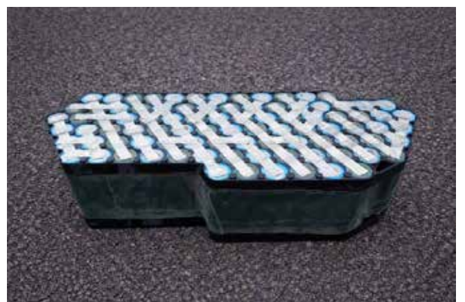
Fotografia 3. Pakiet akumulatorów litowo-jonowych zbudowany z wielu cylindrycznych ogniw, połączonych niklowymi taśmami przewodzącymi. Tego typu konstrukcje są stosowane m.in. w rowerach elektrycznych, hulajnogach oraz innych urządzeniach o większym zapotrzebowaniu na energię. Źródło: opracowanie własne.
