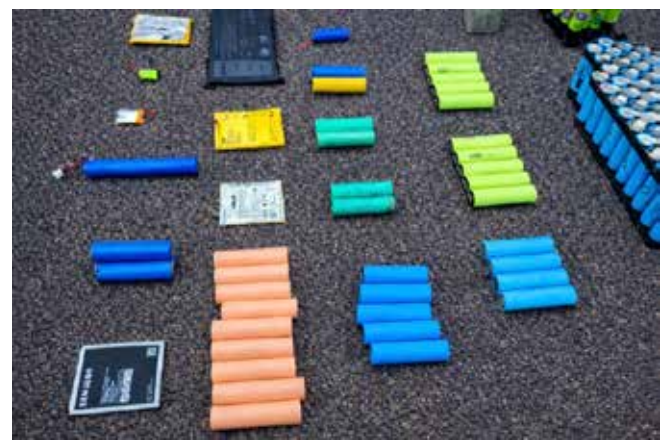
Fotografia 1. Różne typy akumulatorów litowo-jonowych, stosowanych w urządzeniach codziennego użytku – od elektroniki przenośnej po większe pakiety energetyczne. Zróżnicowane kształty i rozmiary wynikają z odmiennych zastosowań oraz wymaganych parametrów pracy. Źródło: opracowanie własne.
