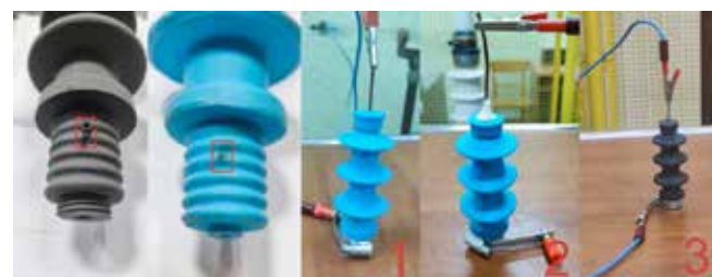
Rys. 3. Transformatorowe izolatory przepustowe - test wytrzymałości dielektrycznej [opracowanie własne].
