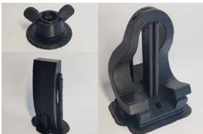
Rys.1. Części składowe uchwytu przelotowego AsXSn -druk FDM [opracowanie własne]
