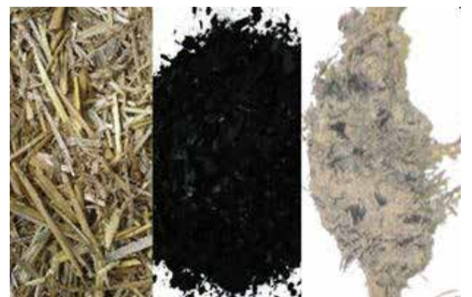
Rys. 1. Od lewej: przykładowa biomasa, wytworzony w wyniku karbonizacji biowęgiel oraz widok fragmentu gleby z ziarnami biowęgla spenetrowanymi przez korzenie roślin.
