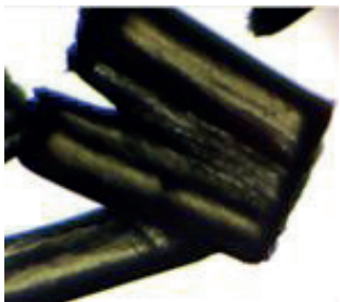
Rys. 1. Fragmenty mikroplastiku (czyścik do naczyń) z polipropylenu (powiększenie 40x)
