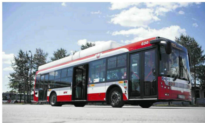
• Po przebudowie zmienił się wygląd autobusu: na dachu, za zbiornikiem na gaz, umieszczono zestaw baterii, które zastąpiły zawodne kondensatory. FOT. GRZEGÓRZ SKOWRONEK / AGENCJA GAZETA
